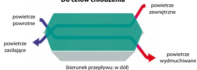
Rysunek 8: Kierunek montażu „na (białe) panele boczne”
